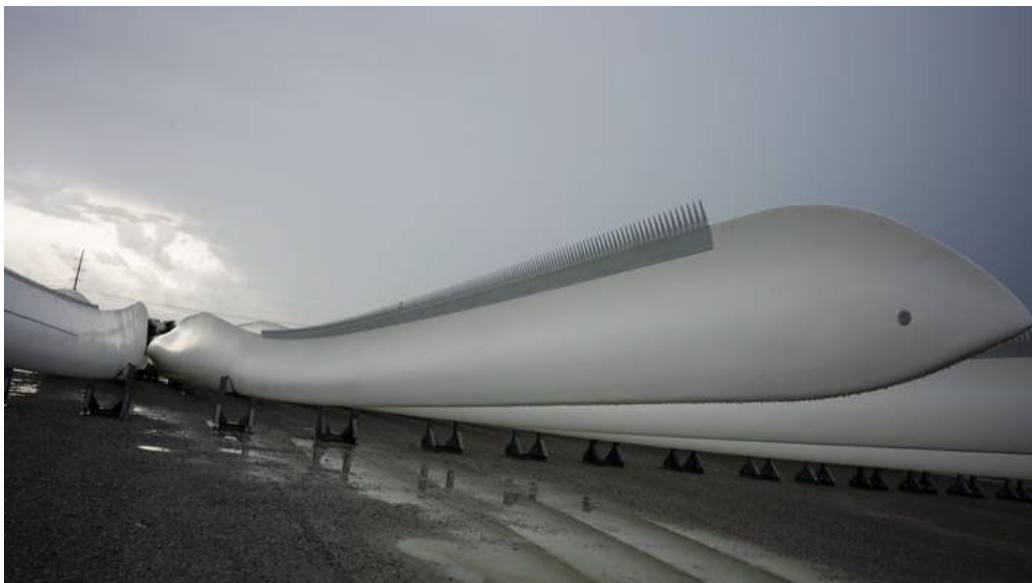
Figure 25: Pale d'éolienne équipée du system TES. (Source : energeia)
